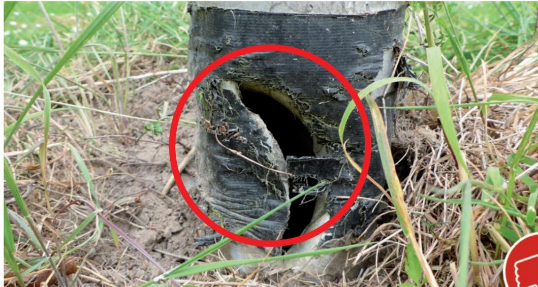
Bild 19: Deutliche Beschädigung am Pfosten
