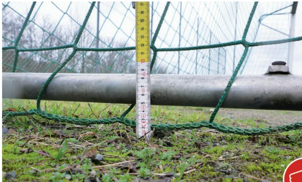
Bild 24: Höhendifferenz zwischen Bodenrahmen und Boden
