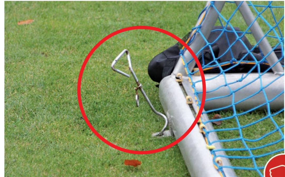
Bild 9: Überstehender, nicht vollständig eingeschraubter Spiralanker
