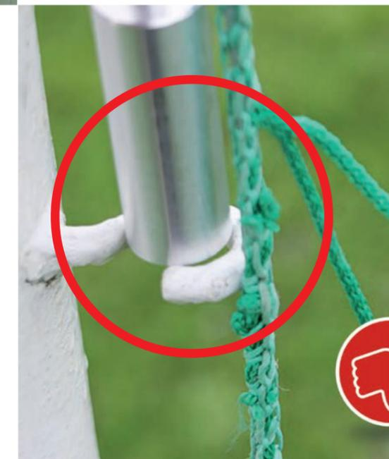
Bild 36: Offener Metallnetzhasen mit Öffnung  $< 25$  mm. Die große Seite des Prüfstabes passt nicht in die Öffnung, d.h. diese ist kleiner als 25 mm und daher ebenfalls nicht zulässig.
